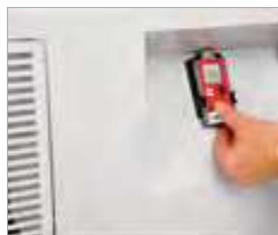
Регистратор данных Data Logger с USB-подключением
