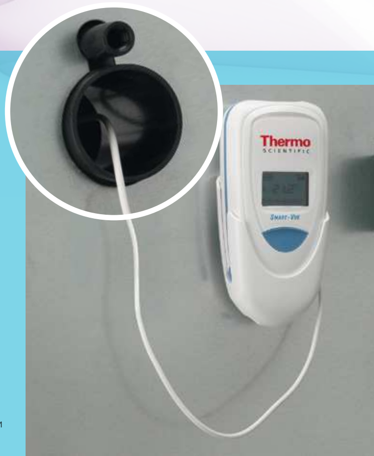
Вид сзади сухожарового шкафа 100 л Advanced Protocol с Smart-Vue
