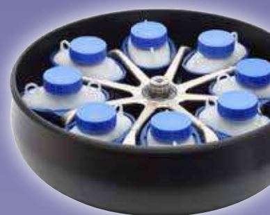
Ротор емкостью 8 x 2000 мл 3900 об/мин 5374 g
